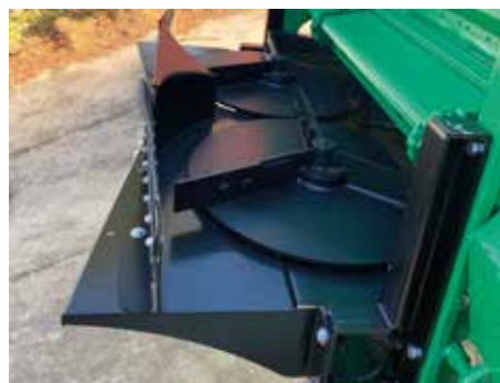
• Platos orientables Tritón 55 ó 75 Adjustable plates Tritón 55 and 75
