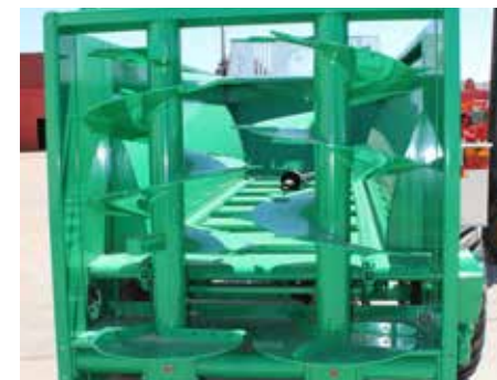
• 2 rulos verticales en Tritón 55 2 vertical auger beater in Tritón 55
