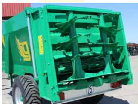
• 2 rulos verticales en Tritón 75, Premium 90/T 2 vertical auger beater in Tritón 75 and Premium 90/T
