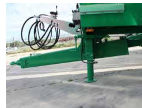
• Apoyo hidráulico con bomba manual (Tritón 95) Hydraulic foot with manual pump (Triton 95)
