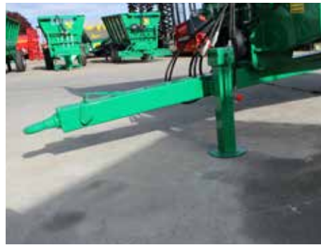
• Lanza de tubo estructural rígida (Galaxy 4P y Tritón 55) Rigid structural tube drawbar (Galaxy 4P and Tritón 55)
