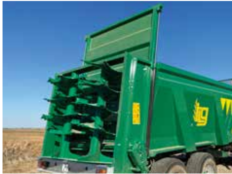
• Puerta hidráulica guiada (Tritón y Premium) Guided hydraulic door (Tritón and Premium)
