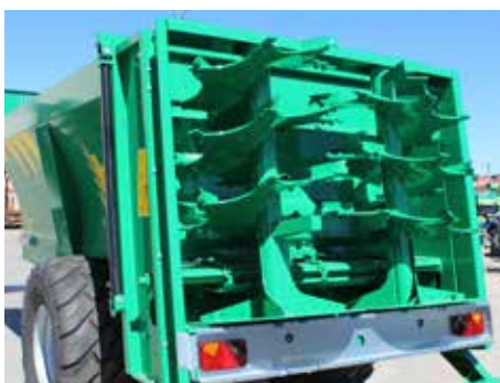
• 2 rulos verticales en Tritón 95, Premium 120 2 vertical auger beater in Tritón 95 and Premium 120
