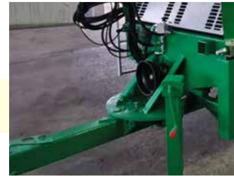
• Lanza con giro hidráulico (Tritón 55 y 75) Drawbar with hydraulic rotation (Tritón 55 and 75)
