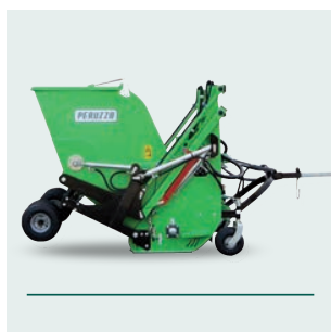
Ruote posteriori per il trasporto con trattori di bassa potenza. Rear wheels for transport with low-power tractors.
