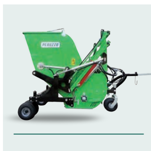
Ruote posteriori per il trasporto con trattori di bassa potenza. Rear wheels for transport with low-power tractors.
