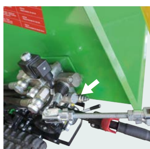
Regolazione velocità rullo. Roller speed regulated.
