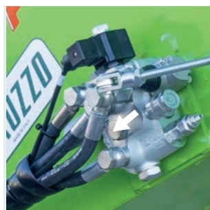
Regolatore velocità rullo. Roller speed controlling.
