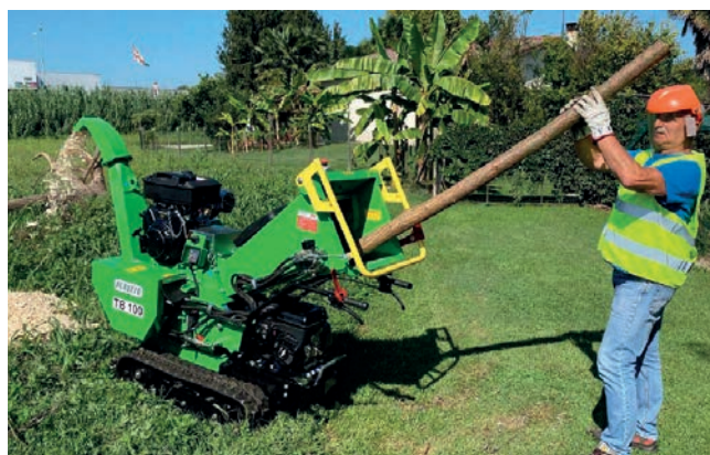
Ampia bocca di alimentazione. Wide Feeding hopper.
