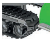
Cingolo con profilo basso. Low Profile Tracks. 40° Max
