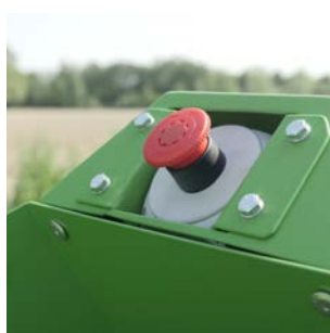
Pulsante di sicurezza arresto motore. Safety knob for stopping engine.
