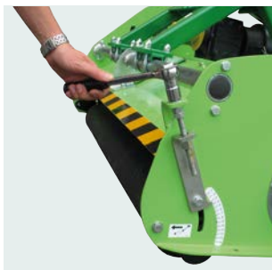
Regolazione di taglio millimetrica. Millimeter cutting adjustment.
