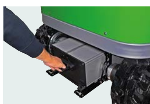
Batteria intercambiabile. Interchangeable battery. 10 kWh
