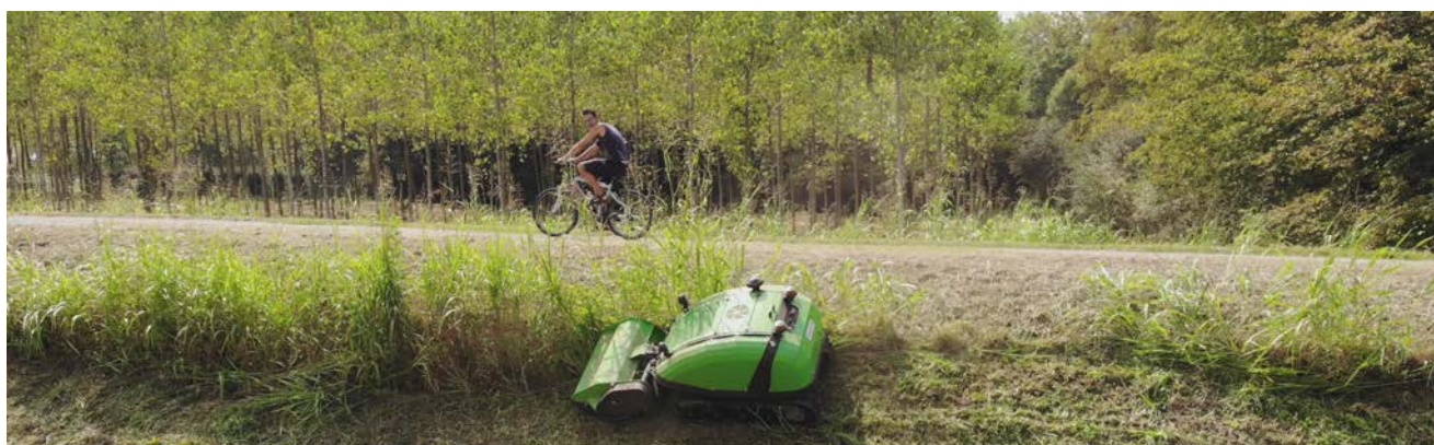
Cingolo con profilo basso. Low Profile Tracks. 40° Max
